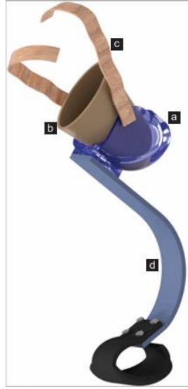
Şekil 5. Ekzoprotezlerin şematik gösterimi: (a) soket, (b) astar, (c) süspansiyon kayışı, (d) şok emici pilon (Arauz ve ark. 2021).
