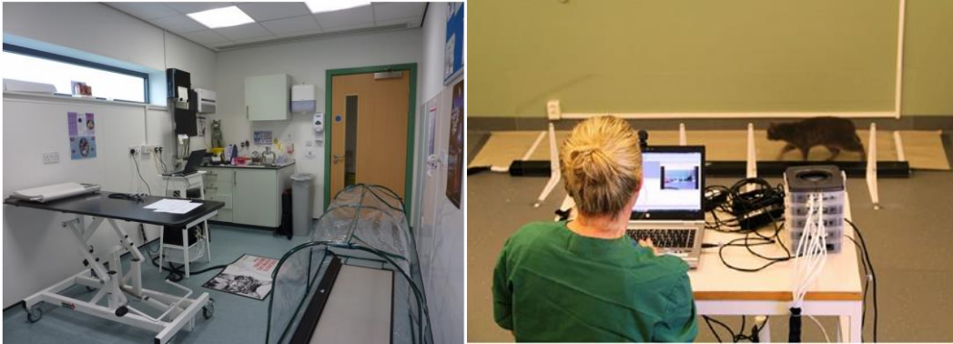
Şekil 12. Kedilerde basınç duyarlı yürüme platformu (pressure-sensitive walkway) ile yapılan ölçüm düzenekleri (Stadig ve Bergh 2014, Dowgray ve ark. 2024).
