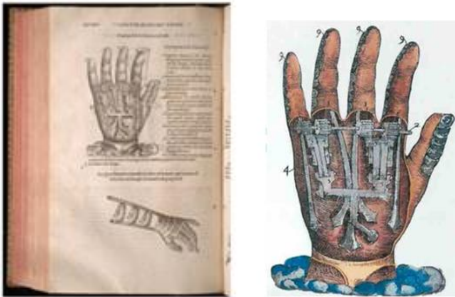
Şekil 2. Ambroise Paré’nin “Le Petit Lorrain” adlı mekanik el protezinin çizimi ve rekonstrüksiyonu (Hernigou 2013).
